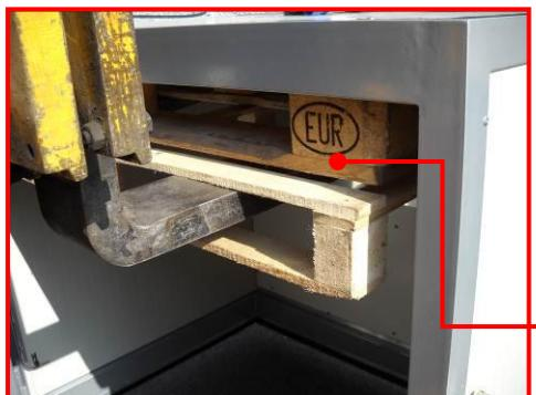
Durch Entfernen der vorderen Klappe kann das Gerät auch mit den Gabeln eines Gabelstaplers angehoben werden. In diesem Fall ist darauf zu achten, dass die Teile innerhalb des Wärmeschanks nicht beschädigt werden. Es ist ratsam, beim Anheben mit dem Gabelstapler immer Paletten zu benutzen, um das Innere des Wärmeschanks nicht zu beschädigen.
