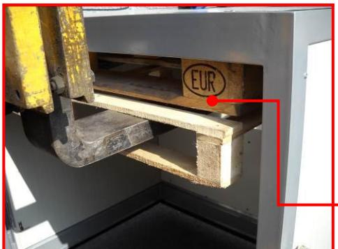
Togliendo lo sportello anteriore, è possibile sollevare la struttura posando le forche di un carrello elevatore sulla parte interna del soffitto. In questo caso porre attenzione a non danneggiare i particolari posti all'interno della camera.
