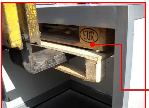
En levant le volet avant, il est possible de soulever la structure en posant les fourches d'un chariot élévateur sur la partie interne du plafond. Dans ce cas faire attention à ne pas endommager les parties se trouvant à l'intérieur de la chambre.
